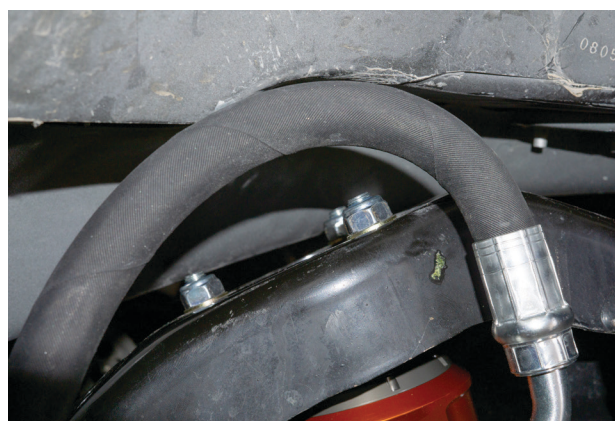
Fig. 40: Attach the top hat nuts.
