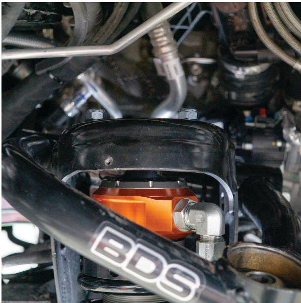
Fig. 12: Mount the top hat nuts.
